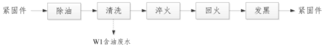
图 2.3-2 紧固件热处理生产工艺流程及产污环节
