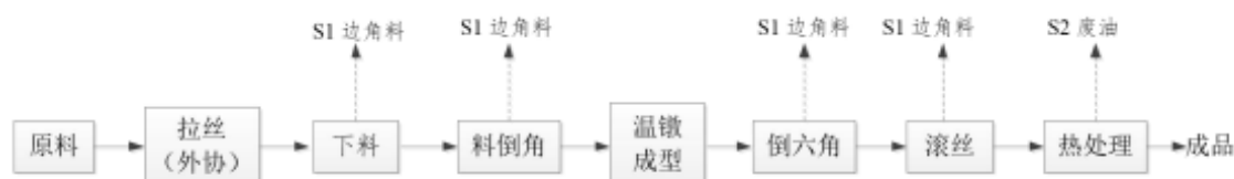
图 2.3-3 螺丝温镦成型生产工艺流程及产污环节
