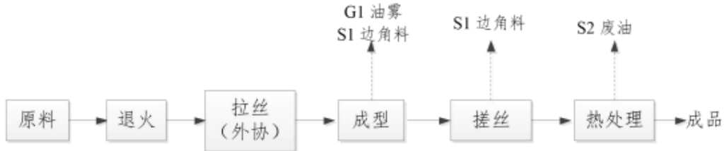
图 2.3-1 螺丝冷镦成型生产工艺流程及产污环节
